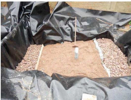
Figura 11: Composição das camadas de pedregulho grosso e fino do módulo II – WCH.
